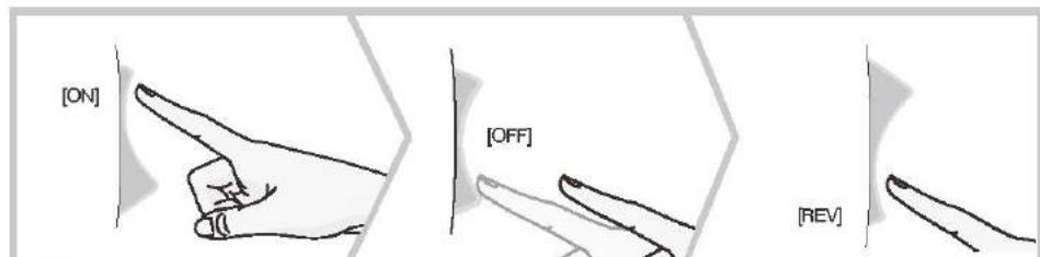
**!** Al cambiar la exprimidora a la posición [OFF], la barrena no se detiene inmediatamente. No cambie el modo de la exprimidora para funcionar en dirección opuesta hasta que no se haya detenido completamente el movimiento de la barrena. Una vez detenida completamente la rotación, podrá cambiar el modo para operar en cualquiera de las dos direcciones.
