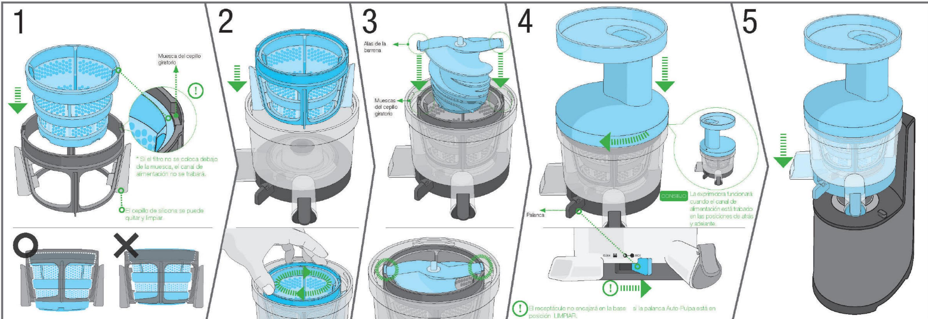
Coloque el filtro dentro del cepillo giratorio. Presione el filtro hacia abajo dentro del cepillo giratorio hasta que el borde superior del filtro quede debajo de las muescas en la parte superior del cepillo giratorio.
